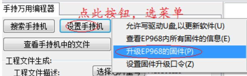
**10.3.2 脱机的切换固件操作:** 在连接 PC 下载 eup 文件到 EP968 内后,需要在 EP968 上进行操作,使新的固件开始工作。步骤是:
